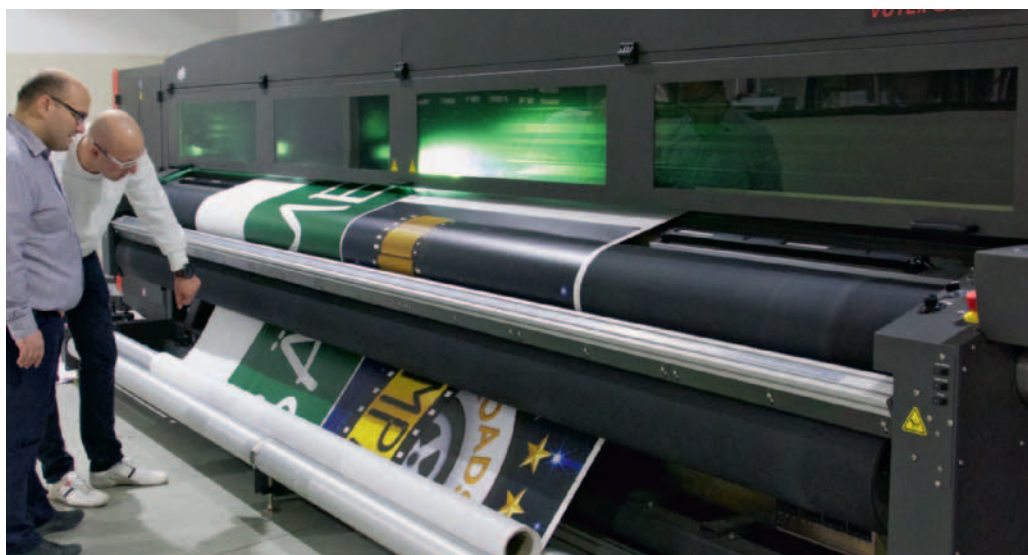
Der EFI Vutek GS5000r druckt in bis zu fünf Meter Breite und mit einer Leistung von 96 Quadratmeter pro Stunde, mit einer Auflösung von 1 000 dpi und 12 pl Tropfenvolumen.
