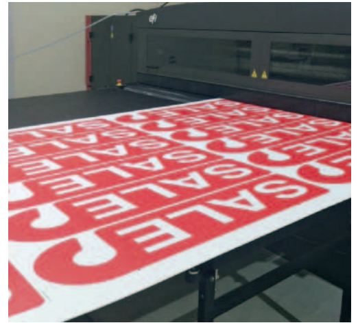
60 Platten im Format 1,20 x 2,40 m druckt der EFI Vutek GS3250LX Pro stündlich.
